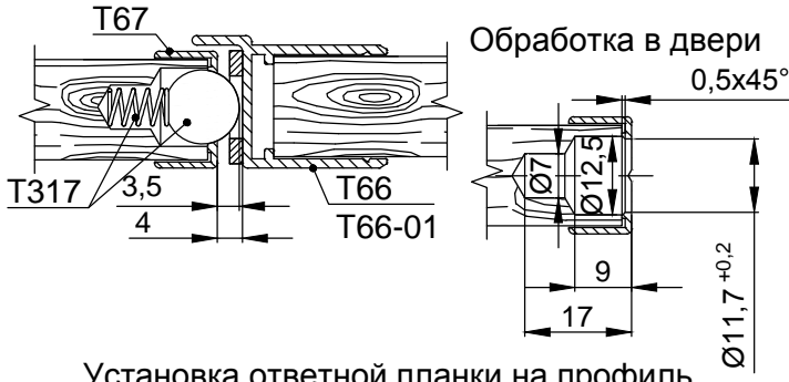
Установка ответной планки на профиль
